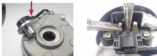
Εικόνα 3: Συμπιεστής A/C ACP 1712 000S με αισθητήρα στροφών
