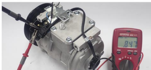
Εικόνα 5: Μέτρηση της αντίστασης του αισθητήρα στροφών
