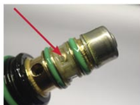
Εικόνα 2: Κολλώδης ουσία στη βαλβίδα ρύθμισης
