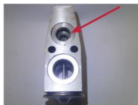
Εικόνα 3: Ρύποι στη βαλβίδα εκτόνωσης
