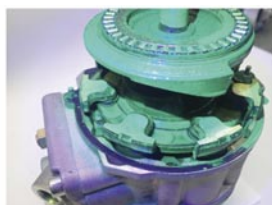
Εικόνα 1: Υπερβολική ποσότητα σκιαγραφικού μέσου στο λάδι
