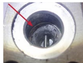
Εικόνα 3: Ρύποι στη βαλβίδα εκτόνωσης
