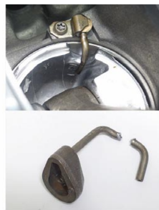
Εικόνα 2: Εγκατεστημένο ακροφύσιο λαδιού ψύξης (επάνω) και σπασμένο (κάτω)
