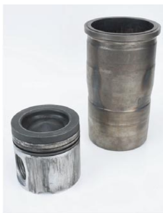
Εικόνα 1: Χιτώνιο κυλίνδρου και υπερθερμασμένο έμβολο FERROTHERM® (κεφαλή από χάλυβα, άξονας από αλουμίνιο) με ίχνη φθοράς
