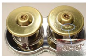
Θερμοκρασίες ανοίγματος για τον θερμοστάτη TX 32D
