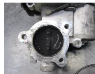
Εικόνα 1: Εξαιρετικά λερωμένο πτερύγιο βαλβίδας EGR
