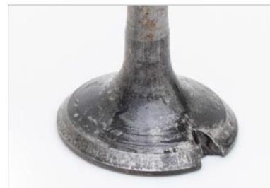
Εικόνα 3: Βαλβίδα με εμφανείς τήξεις
