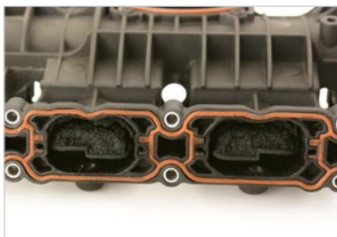
Εικόνα 2: Σωλήνας αναρρόφησης με πτερύγια κατακόρυφου στροβιλισμού
