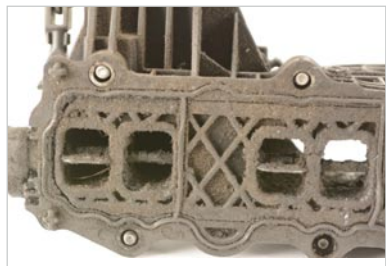
Εικόνα 1: Σωλήνας αναρρόφησης με εναποθέσεις στα πτερύγια οριζώντιου στροβιλισμού
